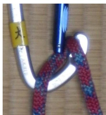
若干補足すれば、図一5 7はクライマー側ロープが空側に出ているということから言えば一見順クリップのように見えるが、これはやはり墜落ロープがゲートを叩いてクリップが外れる虞がある。逆に図一5 8は一見逆クリップのように見えるが、こちらはクライマーが墜落してもゲートが開く可能性は低い。
